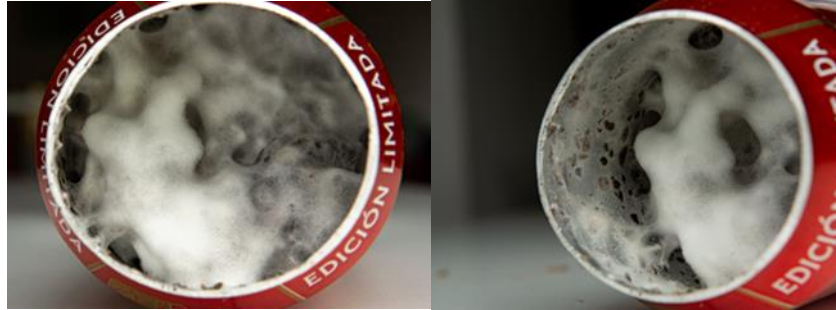
Figura 3. Desarrollo de materiales aislantes en base a micelio fúngico.
